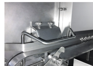
自动启动/停止装置, 降低能耗
