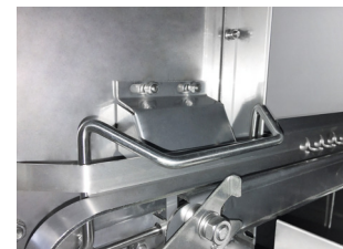
自动启动/停止装置, 降低能耗
